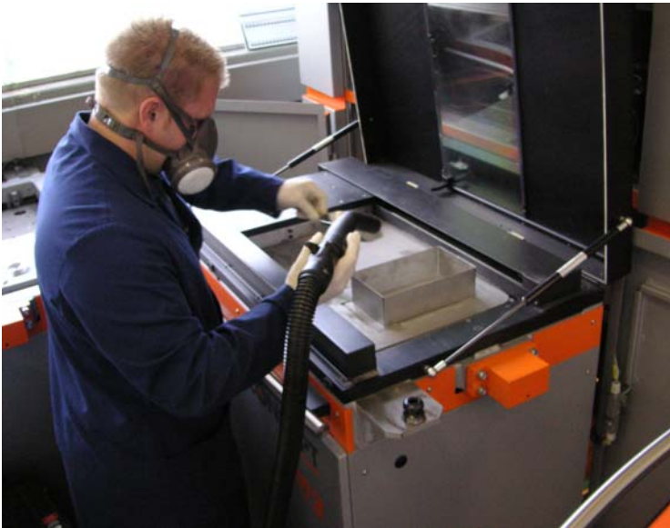
Metallpulver aus Bauraum entfernen und aussieben
