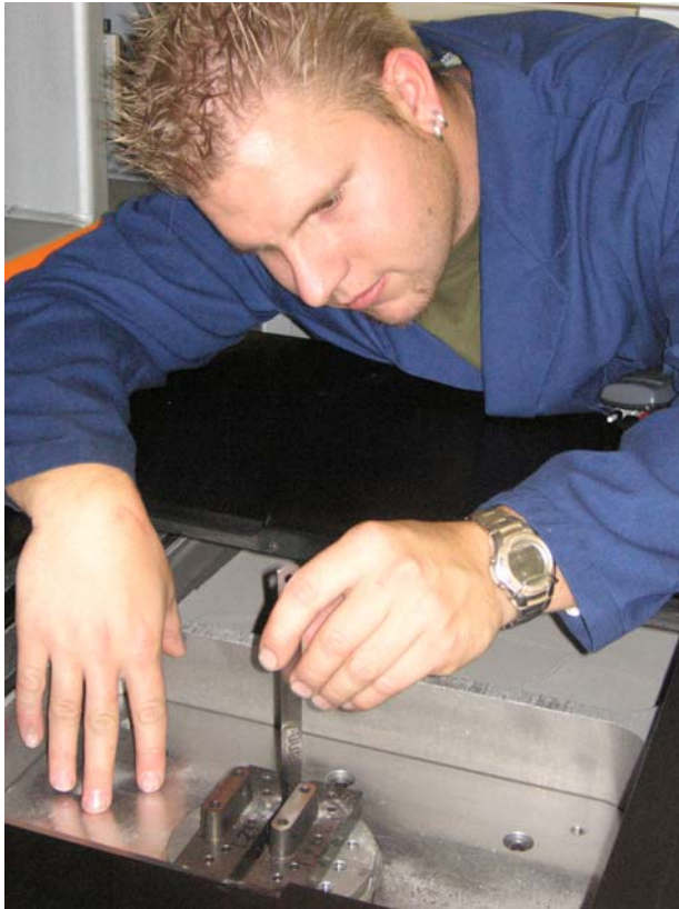
„Hybridbauteile“ auf Bauplatte positionieren und Modul einrichten
