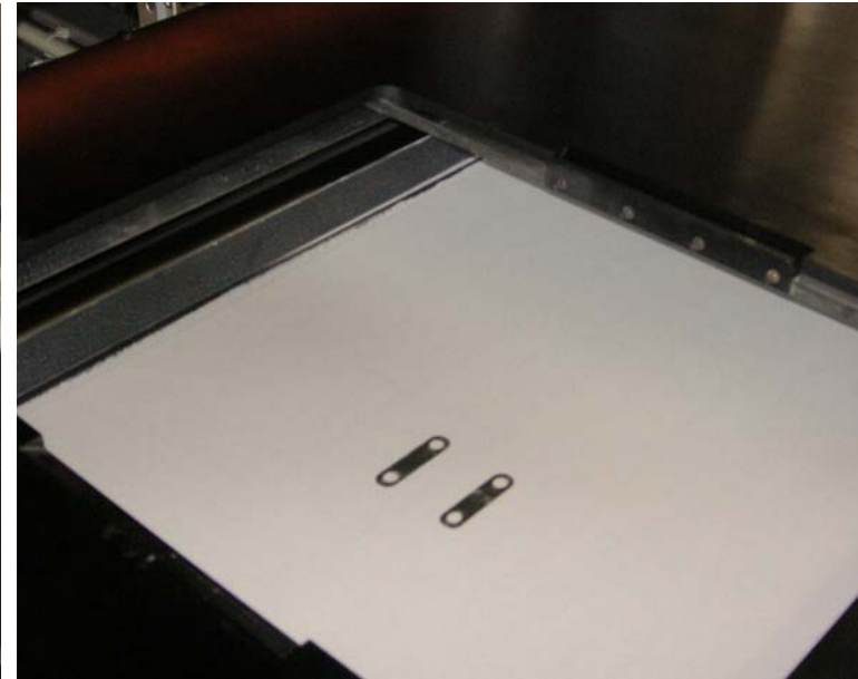
Referenzfahrt durchführen und Kammer mit Stickstoff fluten
